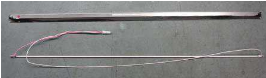
20. Untuk mengakses lampu backlight, Anda harus melepas topi karet dari kedua sisi lampu. Saya tidak yakin apakah Anda dapat menyentuh lampu backlight dengan jari-jari, jadi saya sarankan menggunakan sarung tangan karet.
