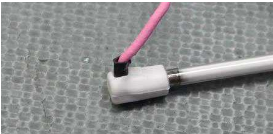
21. Kabel pada kedua sisi lampu backlight disolder ke lead backlight. Untuk mengakses lead Anda harus melepas isolator hitam pada kedua sisi lampu. Unsolder kedua kabel dari lampu backlight tua dan solder ke yang baru
