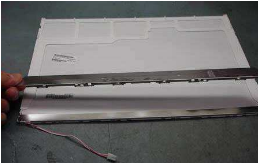
14. Kabel Backlight lamp (CCFL) disalurkan melalui kait plastik kecil.
