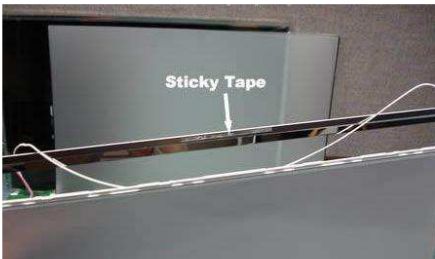
18. Setelah reflektor tidak terikat ke dasar layar, Anda dapat mulai melepas lampu backlight. Seperti yang Anda lihat pada gambar, saya menandai sisi kiri reflektor dengan titik merah jadi saya tahu di mana kabel merah ketika saya merakit semuanya kembali bersama-sama.
