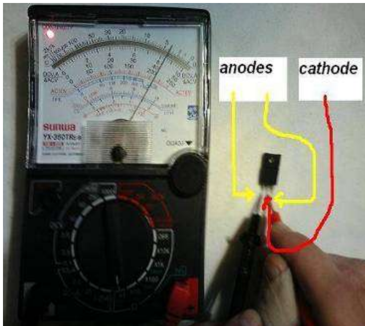
Step 1 Testing Schottky Diode dalam skala x1 ohm
