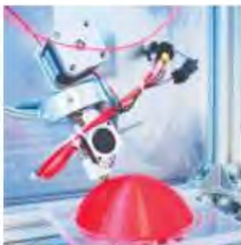
Printer 3D mencetak bidang dengan 5 sumbu. (Sumber: aniwaa.com)
