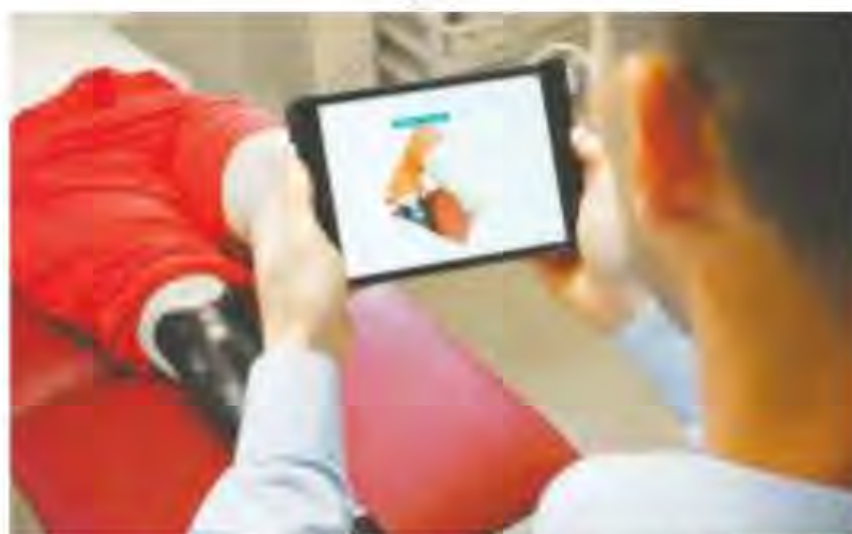
3D scanner mempercepat proses desain soket untuk kaki prostetik. (Sumber: Standard Cyborg)
