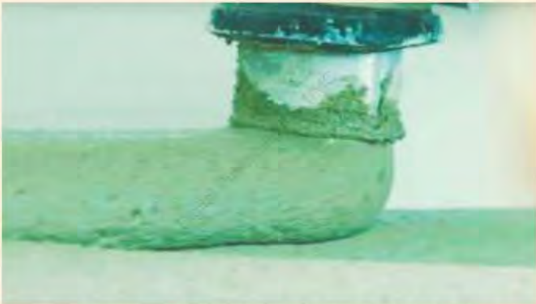
Bahan seperti beton keluar dari pipa dan dibangun lapis demi lapis.
