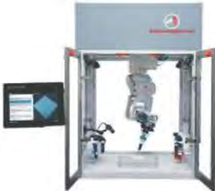
Bioprinter yang menggunakan “ bio ink ” untuk mencetak jaringan hidup manusia. (Sumber: lifescience.solutions )
